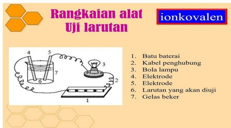
Gambar 1 Rangkaian Alat Uji Larutan
