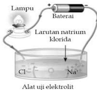
Gambar 2 Alat Uji Elektrolit
